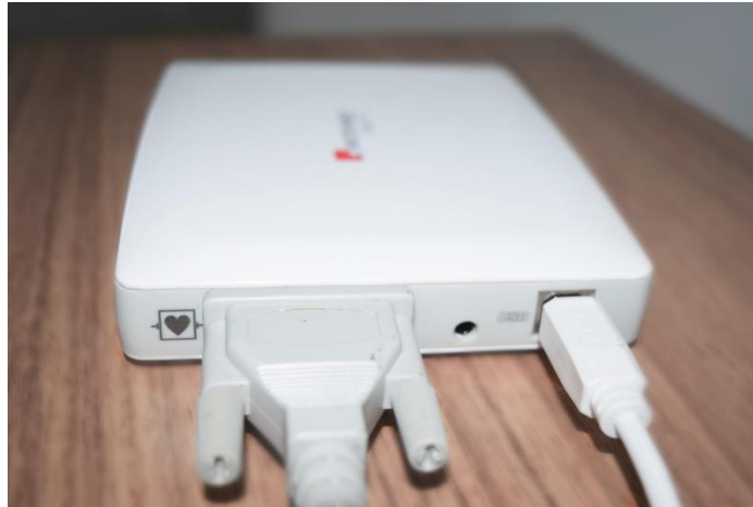
Cabo de Paciente e cabo USB conectado à traseira do ECG – Conector DB15
