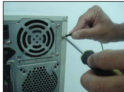
Fixação do cabo de aterramento
